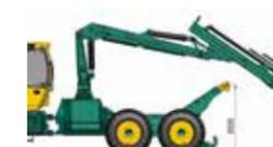
Châssis porte-poulies mobile avec une hauteur de sortie de câbles à 2,0 m
