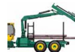
Dernier rancher démontable en position « centrale »
